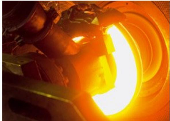
Para evitar que los sensores del sistema antibloqueo de frenos (ABS) o el líquido de frenos o las pastillas se fundan con semejante calor, los discos cuentan con unos canales de recirculación de aire en forma de espiral. No obstante, tanto el líquido como las pastillas son específicos para estos equipos.
