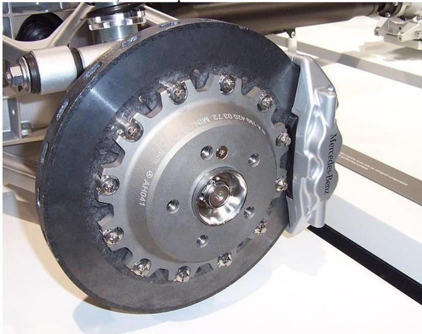
en un horno de alto vacío, y bajo una atmósfera de nitrógeno. A esta temperatura muy exactamente mantenida la cerámica fluye en fase líquida impregnando la fibra de carbono, que la absorbe como si de una esponja se tratara.
