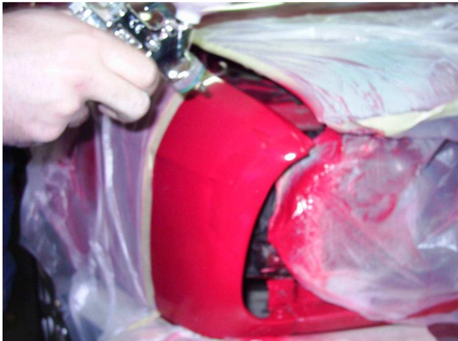
Vaciamos la pintura sobrante y sin limpiar la pistola echamos disolvente de difuminado en la pistola y lo aplicamos por la zona de corte.
