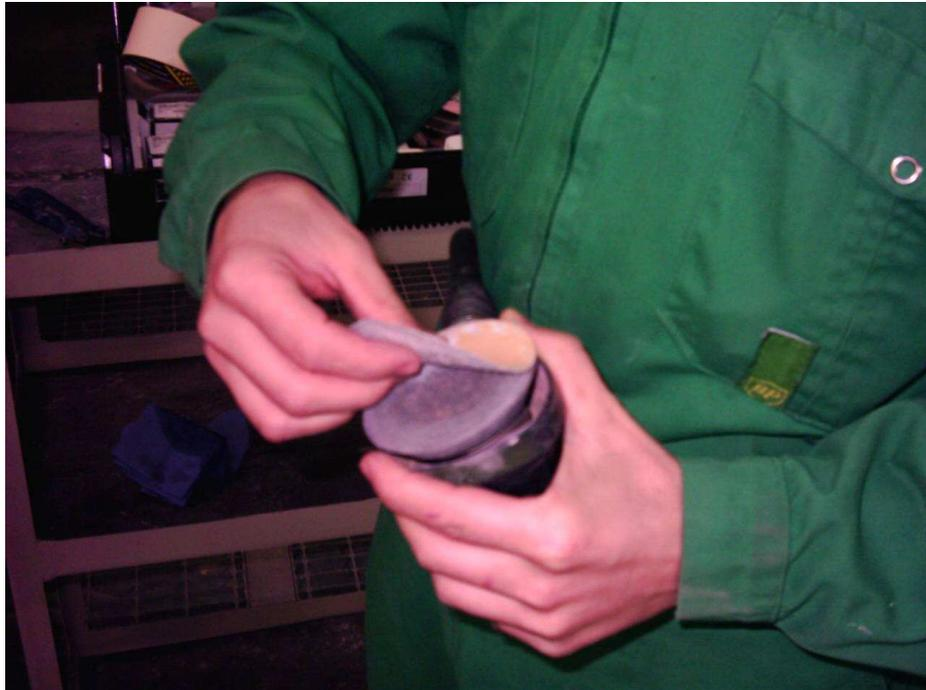
Lijamos utilizando diferentes granos de lija hasta eliminar el daño y obtener una superficie óptima para los posteriores pasos:
