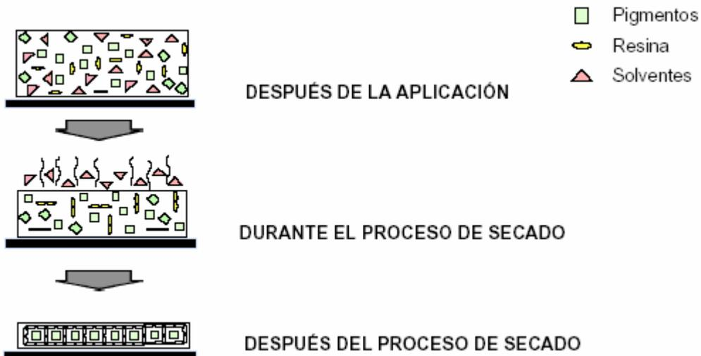
4. *Por IR:* Para ello se utiliza un equipo completo de rayos infrarrojos los cuales calientan la chapa acelerando así el proceso de secado de la pintura.
