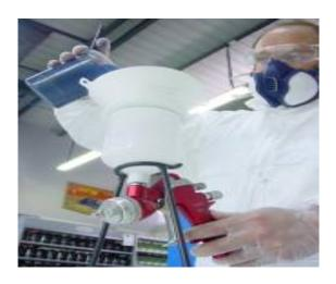
AIREADORES. AL EVAPORAR EL AGUA MÁS LENTAMENTE QUE EL DISOLVENTE, SE RECOMIENDA AYUDARSE, PARA REDUCIR LOS TIEMPOS DE ESPERA ENTRE MANOS, DE UN AIREADOR O VENTURI. ESTA MEDIDA NO ES NECESARIO SI LA CABINA TIENE UN ELEVAD CAUDAL DE AIRE (CERCANO O SUPERIOR A LOS 30.000M³/H) O SI SE ELEVA LIGERAMENTE LA TEMPERATURA DURANTE LA APLICACIÓN. TAMPOCO SERÁ NECESARIO CUANDO LA SUPERFICIE APLICADA SEA MUY GRANDE.
