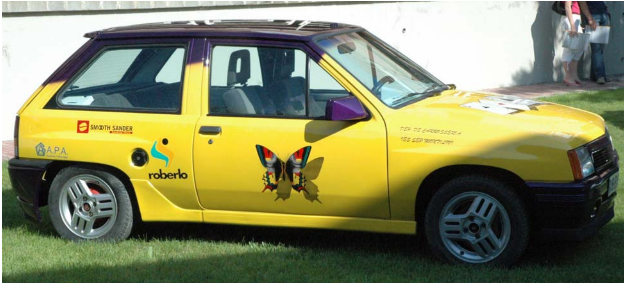
Vehículo de crédito de síntesis realizado por alumnos del instituto Montilivi - curso 2003- 2004- Técnica de pintado con pintura bi capa, utilización de mascarar y aerografos.
