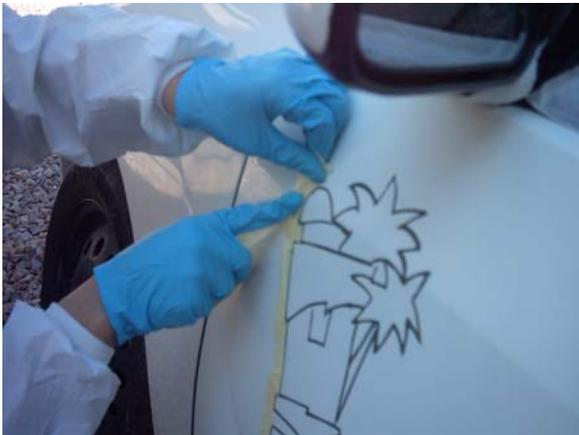
6.1Con las plantillas ya pegadas, enmascararemos los contornos, ajustando la cinta estrecha a los bordes, sin llegar al interior del dibujo, esto produciría cortes en la pintura, y una mala imagen.
