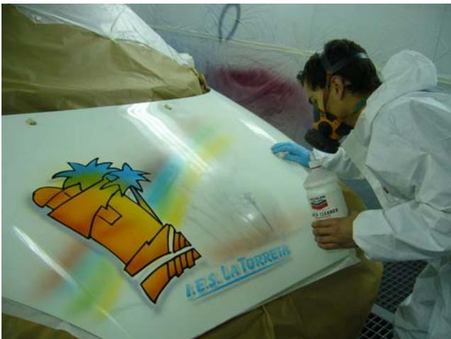
12.Para la limpieza y el desengrasado de las zonas a lacar, utilizaremos un antisiliconas base agua que contiene una mezcla de alcohol y agua.
