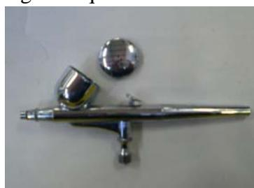
Se empuja hacia abajo para dejar paso al aire y, a continuación, se empuja hacia atrás para devolver la aguja a su posición inicial dentro de la boquilla de dispersión y permitir el paso de pintura a la corriente de aire. De esta forma es correcta la proporción de aire y pintura, pero durante el trabajo es inalterable la mezcla.
