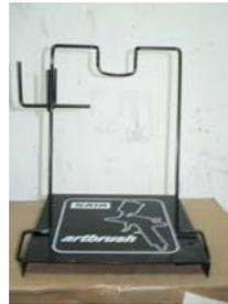
Generalmente al comprar un aerógrafo ya te dan una pieza similar a esta. Sirve para que el aerógrafo esté en posición vertical y si tiene pintura en el depósito no se nos caiga. Aparte cada vez que tengamos que dejarlo para cortar una máscara u hacer otra cosa, el depositarlo ahí es muy cómodo.
