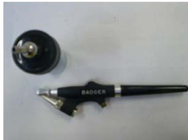
El aire del aerógrafo pasa por el extremo final del tubo, succiona la pintura y la introduce dentro de la corriente de aire. La pintura no llega a atomizarse y sale en forma de diminutas gotas que no dejan un aspecto limpio.
