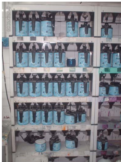
(Armario encargado del removido de las pinturas)
