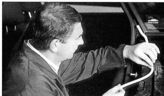
Figura 4.5. Aplicación de burlete de puertas.
