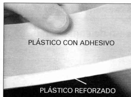
Figura 4.8. Estructura de la cinta para molduras.
