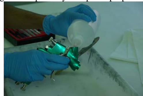
Limpiamos el conducto echando disolvente.
