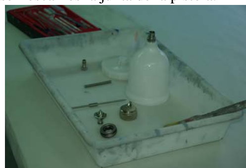
Quitamos la junta de los acoples de la pistola. Depositamos la junta en la bandeja.
