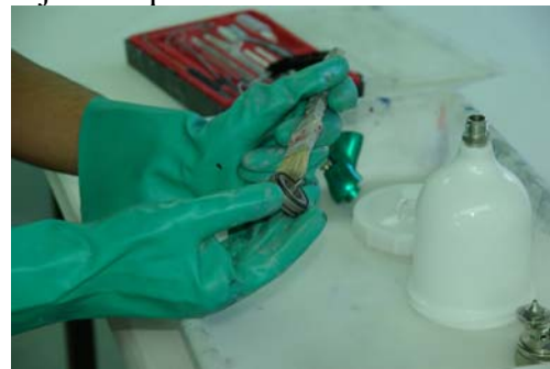
Limpiamos exterior e interior con el pincel.
