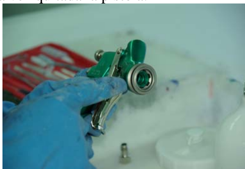
La junta de la boquilla de fluido.
