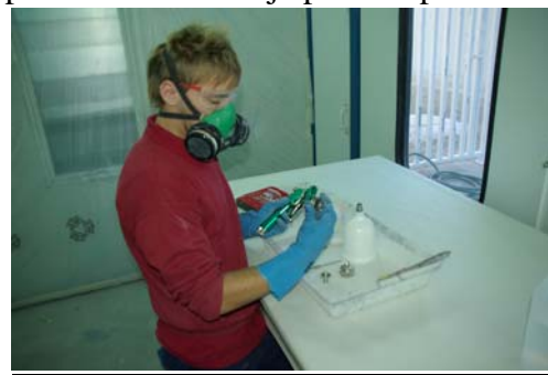
Desenroscamos la junta de la pistola.
