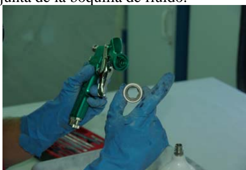
Quitamos la junta de los acoples de la pistola. Depositamos la junta en la bandeja.
