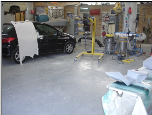
Falta de orden, zonas de trabajo no delimitadas.
