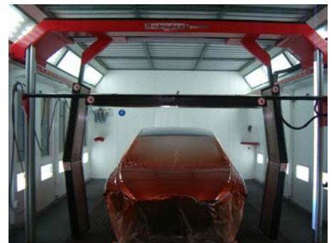
Figura 22 Muestra de los dos planos de secado del Easydry
