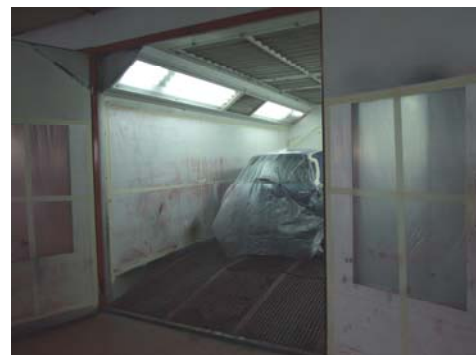
Figura 16. Cabina preparada para la emisión de VOC.
