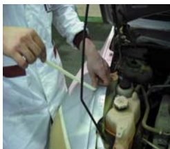
Delinear las áreas cercanas a la reparación.
