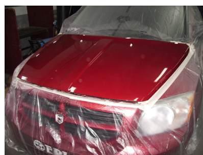
Cubrición con film plástico y recortando la zona del capó.
