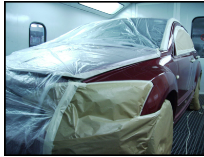
Cubrición con film plástico y recortando la zona lateral.
