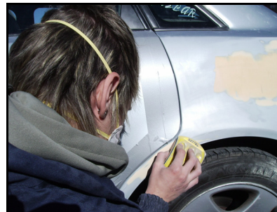
Enmascarado con cinta americana del borde de la puerta para protegerlo durante el lijado.
