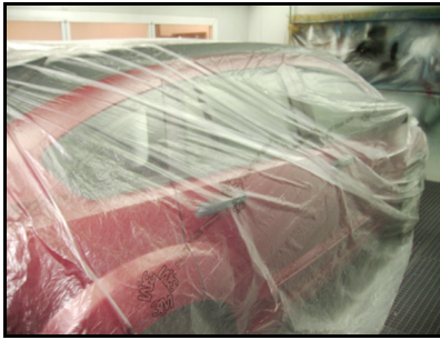
Cubrición con film plástico y recortando la zona lateral.
