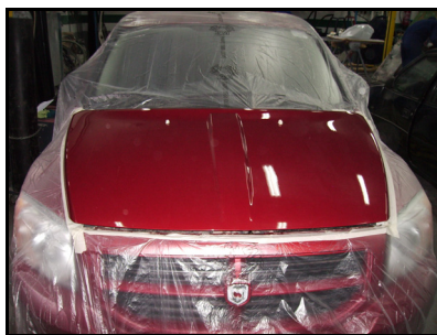
Cubrición con film plástico y recortando la zona del capó.
