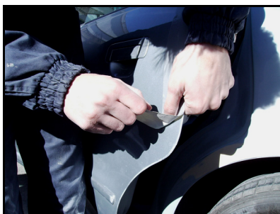
Enmascarado con cinta americana del borde de la puerta para protegerlo durante el lijado.
