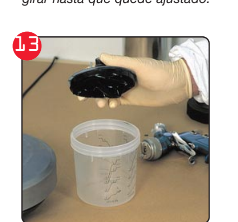
13 Al finalizar el proceso de pintura, el vaso de un sólo uso y la tapadera pueden ser fácilmente eliminados.
