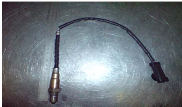
Sonda lambda convencional de dióxido de zirconio ( ZrO_2 ).
