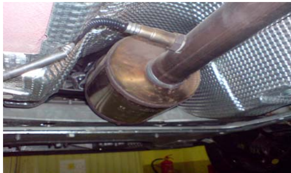
Segunda sonda lambda tras el catalizador.
