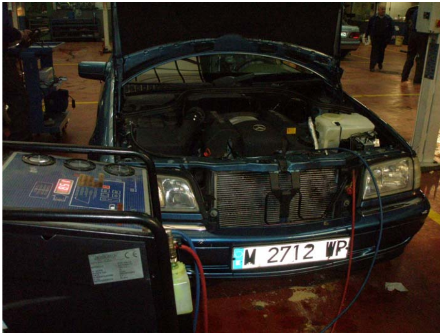
Extracción del gas refrigerante en el vehículo Mercedes Benz equipado con climatización automática en el concesionario ONDO Mercedes de Vitoria
