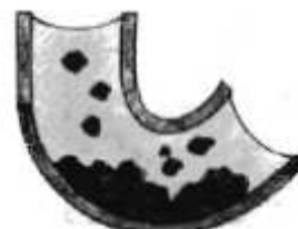
Circuito con formación de depósitos.
