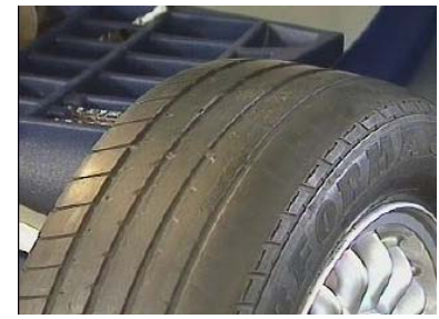
Figura 28. Desgaste exterior por caída positiva.
