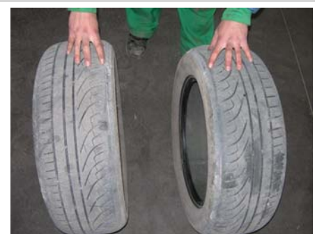
Figura 26. Desgaste por divergencia
