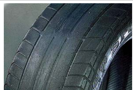
Figura 31. Desgaste por sobrepresión.
