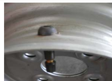
Figura 22. Montaje de la válvula
