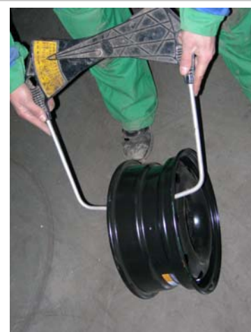
Figura 5. Medición de la anchura de la llanta.
