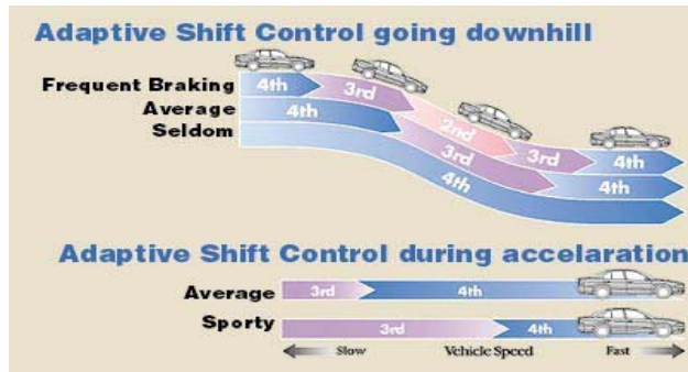
Respuesta del INVECS II ante un descenso y una aceleración
