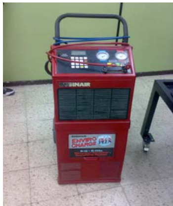
Estación de Carga Automática.
