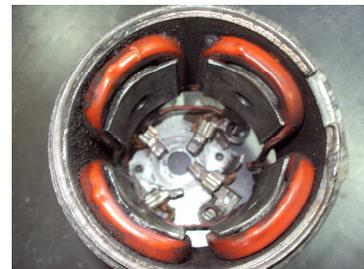
Hoy en día el campo magnético que generan las bobinas es sustituido por imanes permanentes en motores de un par motor no muy alto destinados a turismos.
