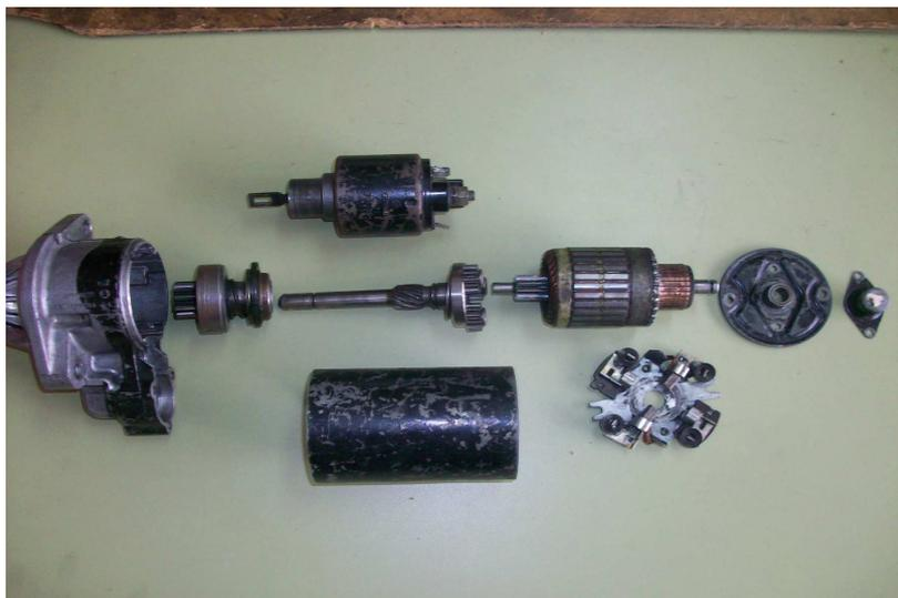
El motor de arranque está compuesto por los siguientes elementos: Carcasas, Bobinas Inductoras, Inducido o Rotor, Piñón de Arrastre, Escobillas, Contactor Electromagnético y Casquillos de Bronce Grafitado.
