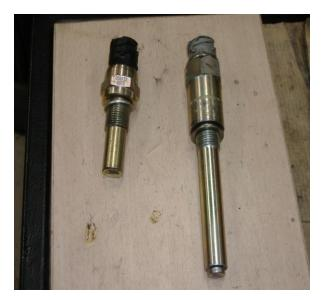
Los emisores inductivos generan la seña de impulsos gracias al giro realizado por los dientes de la corona dentada de la caja de cambios frente al imán situado en los extremos del sensor.
