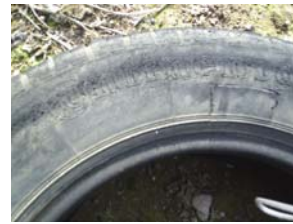
Grietas en la goma
