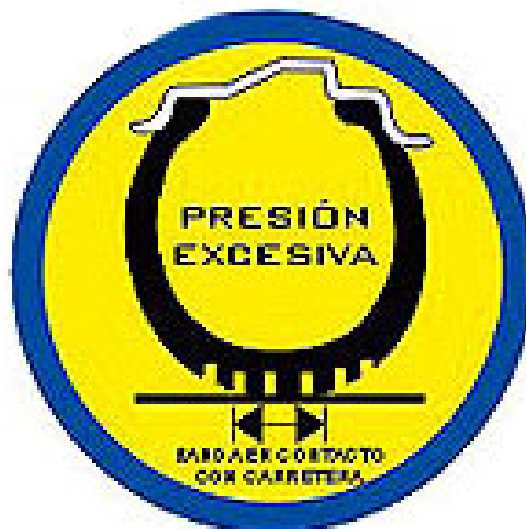
Neumático con exceso de presión
