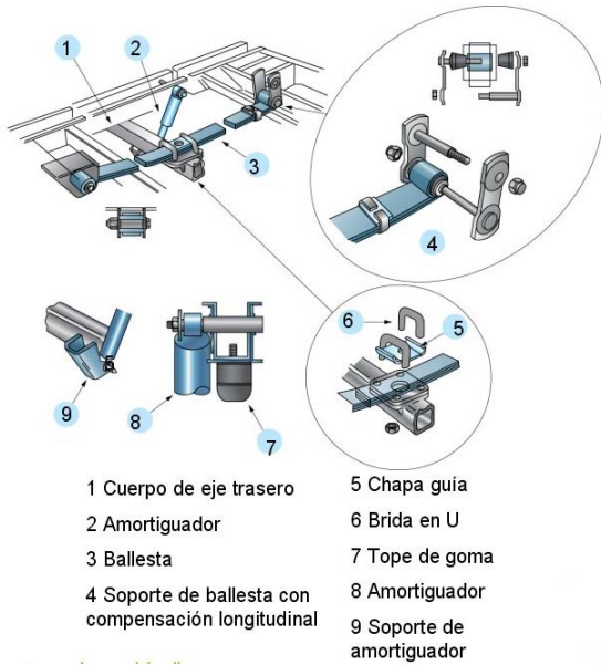
Fig. 5. Ballesta y sus componentes
