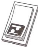
Figura 19. Interruptor de mando para el control del elevador neumático de bogie con su signo característico de identificación.
