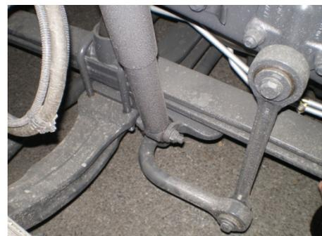
La barra estabilizadora va fijada al bastidor mediante barras de acoplamiento y al eje mediante rótulas, usando las fijaciones en bujes de goma que evitan ruidos y proporcionan un funcionamiento más suave.
