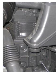
comprimido sale hacia el depósito húmedo o en determinados sistemas pasando antes por un secador de aire. El aire que es suministrado por el compresor es utilizado por el sistema de frenos del vehículo y también por la suspensión neumática, también puede darse el caso de que el aire producido sea utilizado por otros elementos auxiliares del vehículo.
