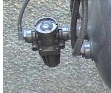
Si el sistema de alimentación cuenta con un secador de aire, el regulador de presión acciona la válvula de drenaje del secador, abriéndola o cerrándola para las presiones de funcionamiento máxima y mínima.
