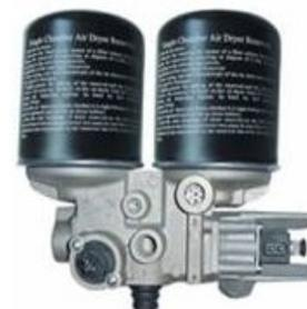
Las torres del secador son las encargadas de retirar toda la humedad que exista en el aire, cuando el aire pasa a través de estos recipientes uno se encarga de absorber la humedad y secar el aire y el otro contiene el aire al cual se le haya absorbido toda la humedad. En algunas versiones las torres pueden ser sustituidas cuando su capacidad absorbente llega a su fin.
