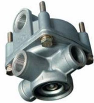
El sistema de frenos también cuenta con una válvula relé específica para el freno de estacionamiento, para que el aire no deba recorrer todo el camino de regreso hasta el mando manual.
