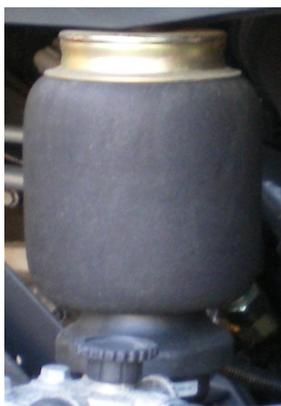
Cuando aumenta la carga, los fuelles se comprimen y el sistema aumenta la presión de aire para compensar esto y elevar nuevamente el chasis a su altura prefijada. Gracias a esto, el vehículo se mantiene nivelado, aún si la carga se efectúa de forma irregular o varía el peso de la misma. Dentro de los fuelles existe un resorte de goma hueco para asegurar que se pueda conducir el vehículo aún si se perforara el fuelle.
