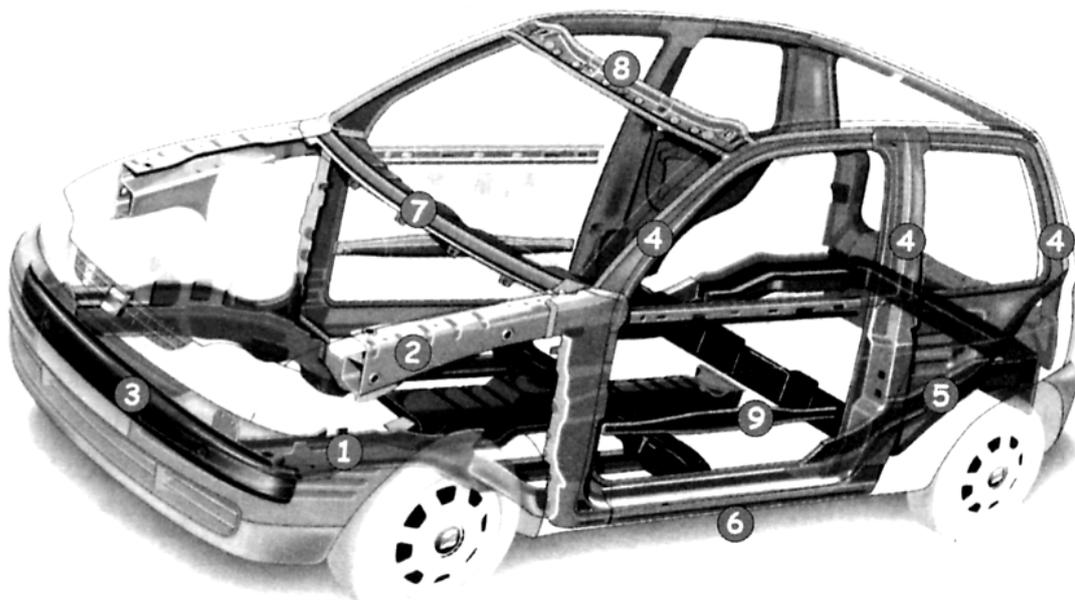
1. **Largueros delanteros:** Son dos vigas paralelas que parten del travesaño delantero. Estas dos piezas son las encargadas de absorber casi la totalidad de la energía producida en caso de impacto frontal. Esta energía es absorbida por los pliegues ubicados en los extremos delanteros de los largueros, de forma que este se repliega arrugándose sobre si mismo.
