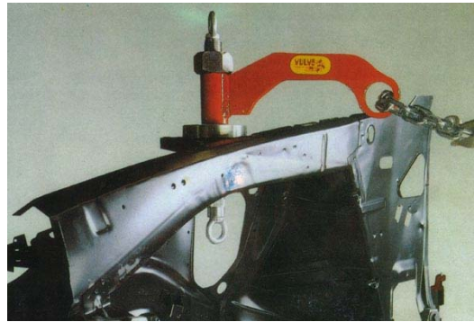
Sistema de tiro de amortiguador tipo MC Pherson
