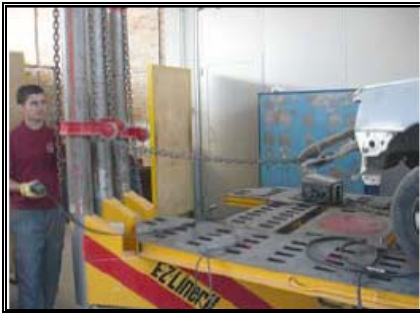
Colocación incorrecta al realizar los tiros.
