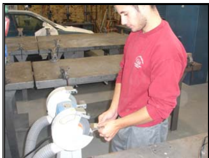
Usar máquinas sin resguardos.
