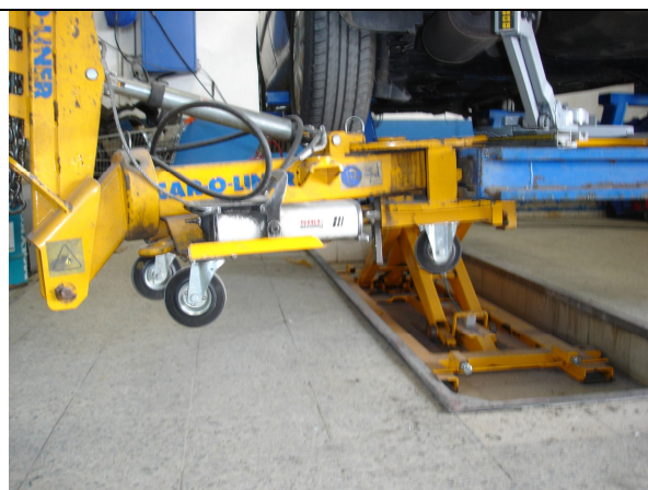
Elevación del vehículo con la escuadra preparada para trabajar.
