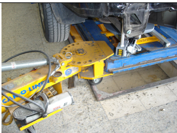
Colocación de la escuadra de tiro.
