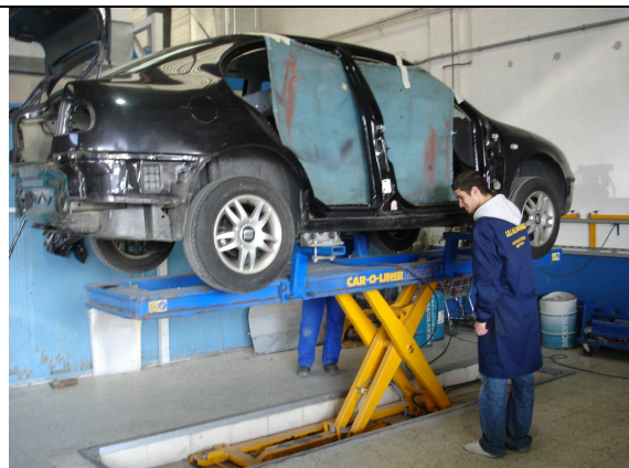
Anclaje y elevación del vehículo
