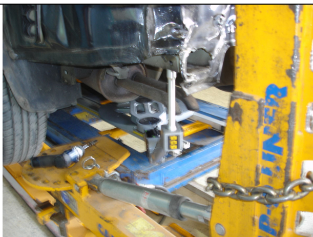
Colocación del brazo en el punto corregido para comprobar que se hizo correctamente .
