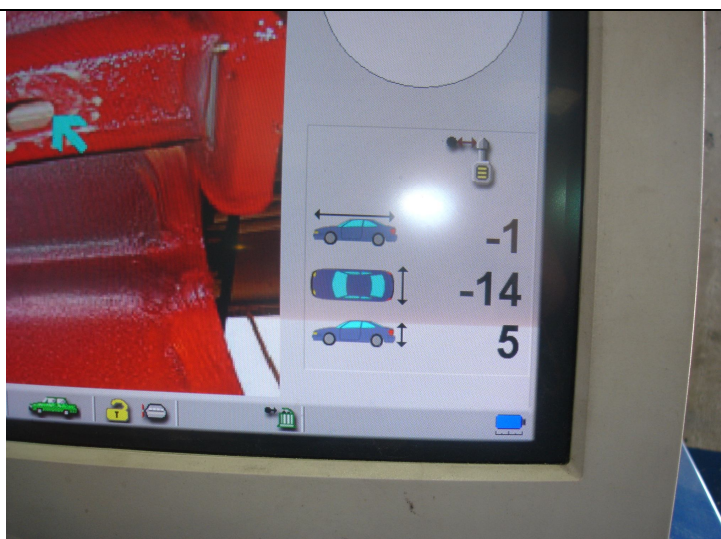
Comprobación en el ordenador de las desviaciones en los puntos medidos.
