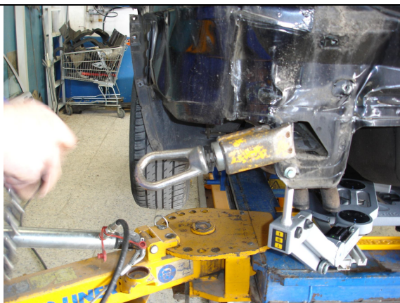
Colocacion de la mordaza adecuada.
