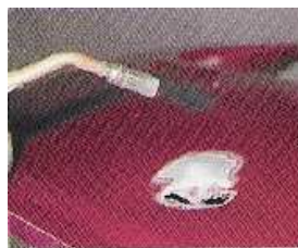
El atemperado previo evitará problemas en la soldadura
