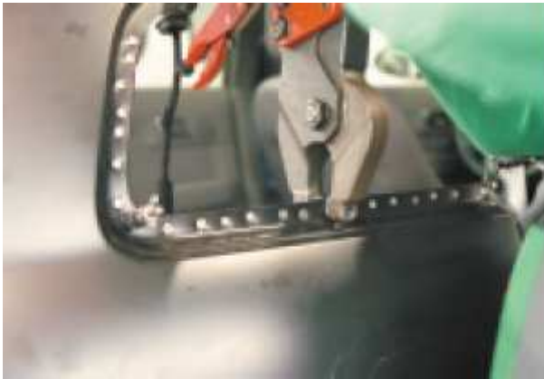
Remachado en una carrocería de aluminio
