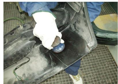
la aplicación simultánea del calor y presión. El calor se aplicara por toda la zona y la presión se ejercerá por la parte interna de los puntos bajos.
