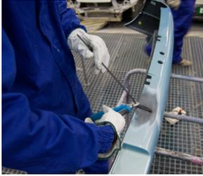
Cuando la varilla se haya enfriado cortar el extremo no soldado lo mas próximo posible a la soldadura.
