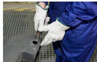
anchura mínima de 1,5-2 cm. y debe realizarse, bien con una lijadora de cinta, con grano P-80, P-100 ó con algún tipo de fresa-muela para plásticos.
