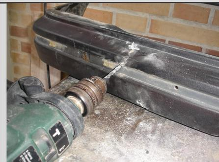
Después se ensancha la grieta para que entre el pegamento y sujete la pieza
