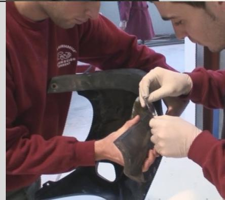
Por el interior utilizamos una malla para dar mayor resistencia al pegamento
