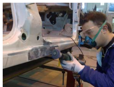
(Lijado con disco abrasivo Clean'n streap)
