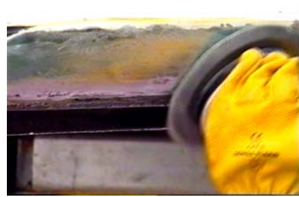
(Lijar la superficie con un disco abrasivo P-100)
