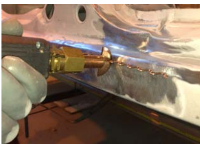
(Soldar el muelle de cobre usando el útil para éste fin)
