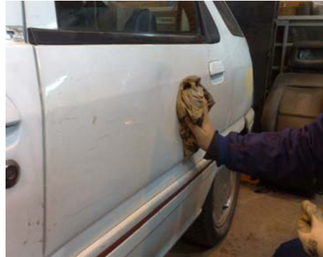
(Limpieza y humedecido de toda la zona)
