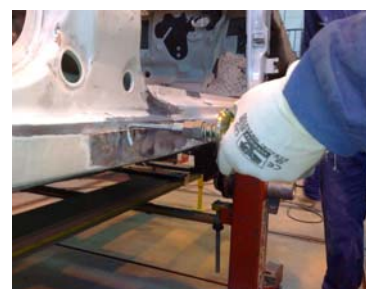
(Tirar del muelle con el martillo neumático hasta extraer el golpe y lijar la superficie)
