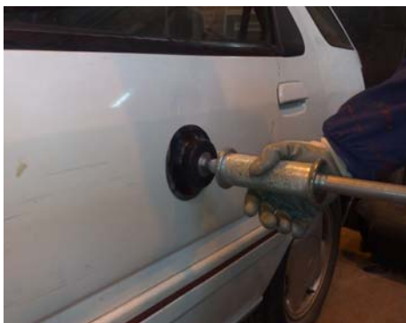
(Extraer la deformación mediante la masa)
