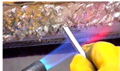
(Aplicar el estaño hasta que desaparezcan las irregularidades)
