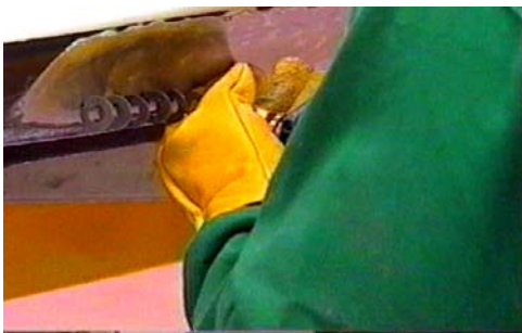
(Una vez soldadas las arandelas, introducir un pasador para poder tirar de todas a la vez)
