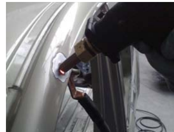
(Aplicación de calor mediante electrodo de cobre)
