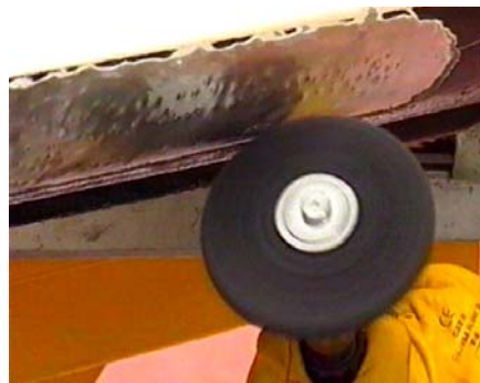
(Si el resultado es el deseado, lijar de nuevo la superficie)
