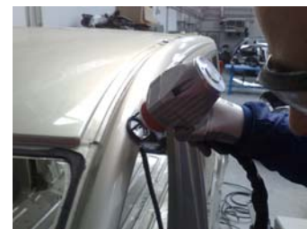
(Reparación con equipo airpuller)
