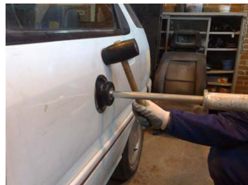
(Mantener la ventosa en tensión y dar unos golpes con el mazo de goma para aliviar tensiones)
