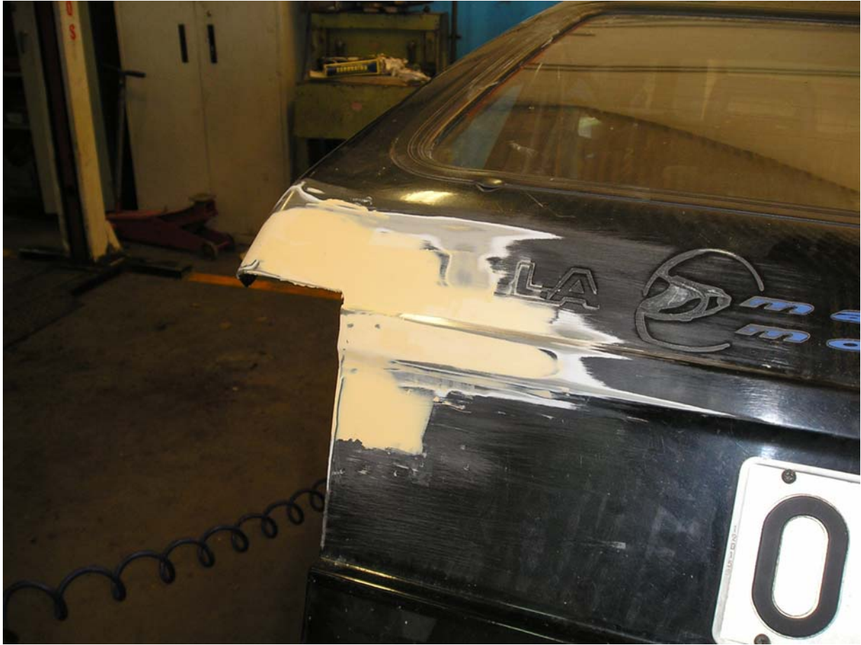
ABOLLADURA CON LA MASILLA LIJADA
