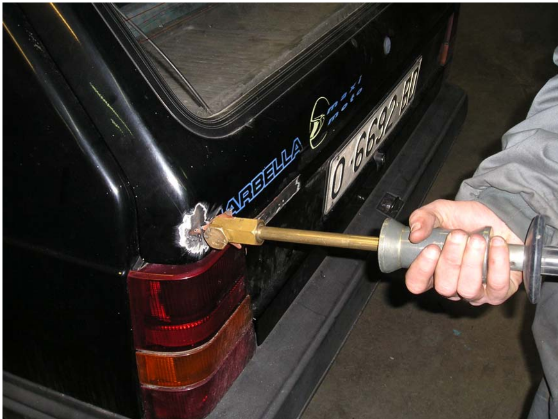
REALIZACIÓN DEL TIRO CON EL MARTILLO DE INERCIA
