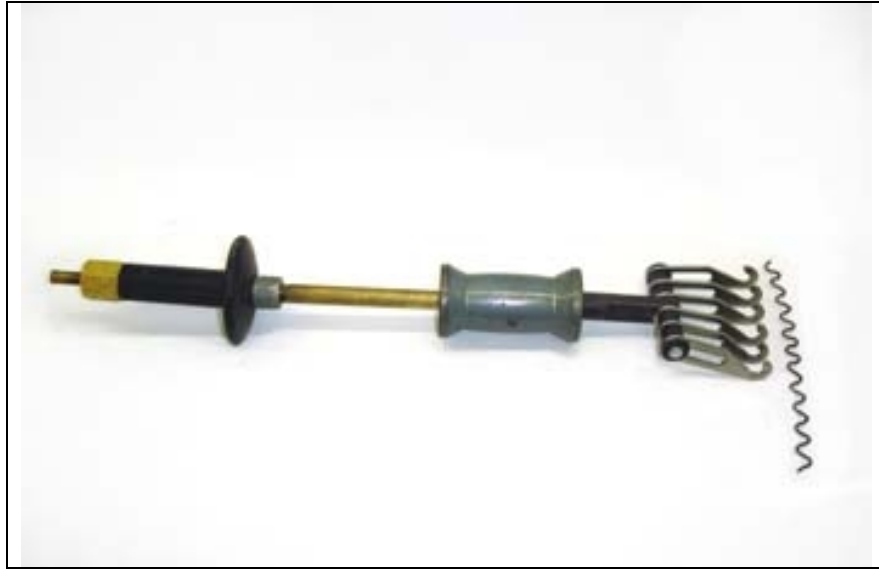
MARTILLO DE INERCIA CON UTIL PARA REALIZAR TIROS EMPLEANDO ALAMBRE ONDULADO
