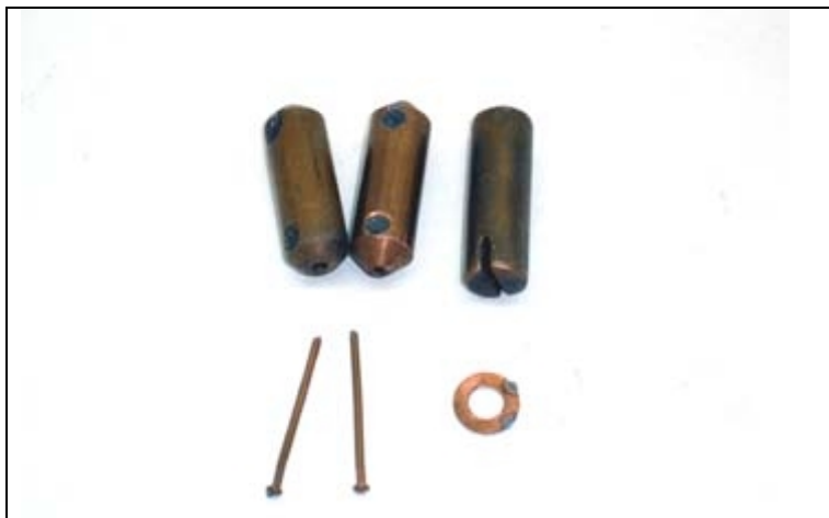
PUNTA PARA LA SOLDADURA DE ARANDELAS Y PUNTA PARA LA SOLDADURA DE CLAVOS.
