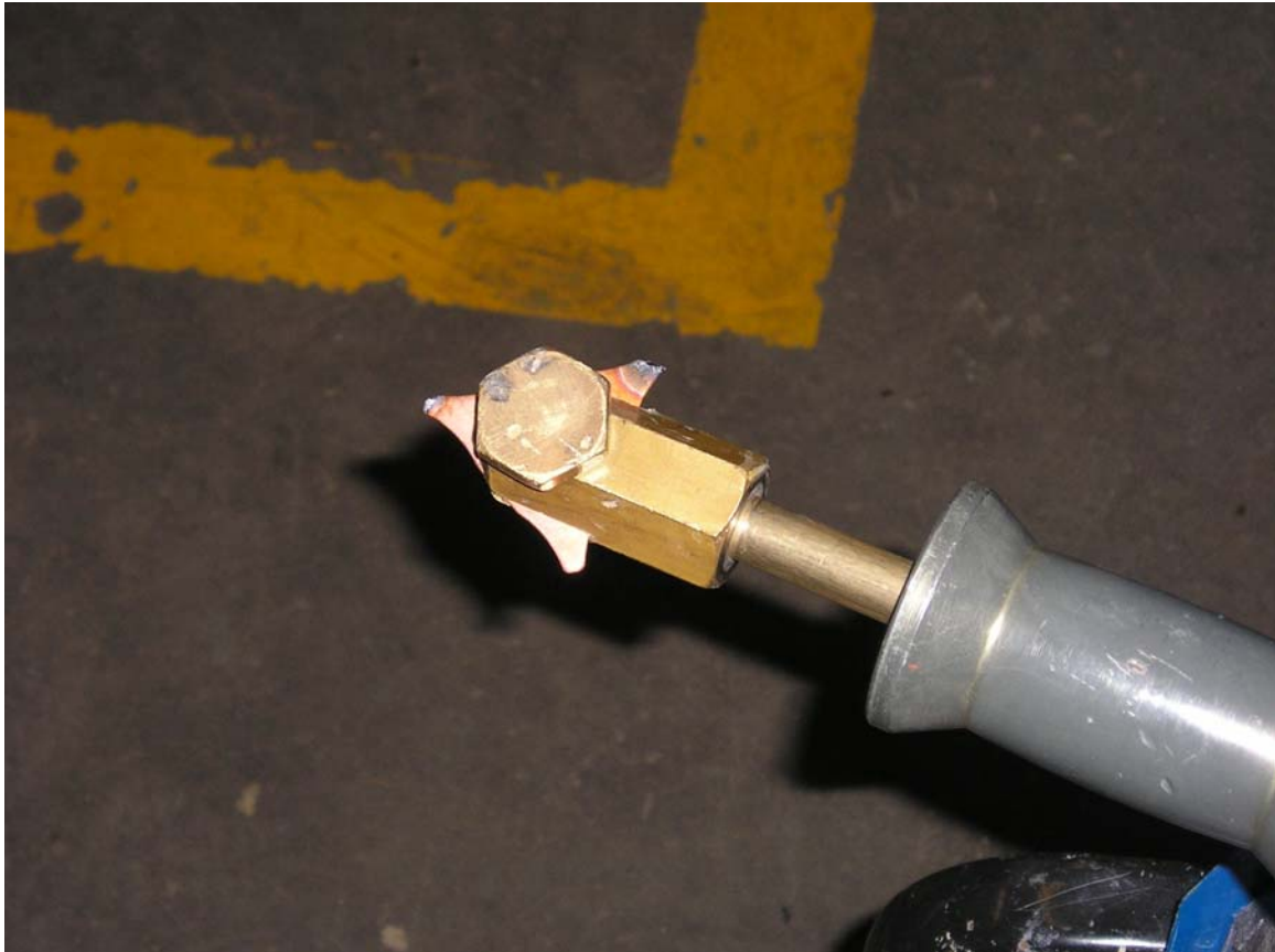
ESTRELLA CON LAS PUNTAS DETERIORADAS
