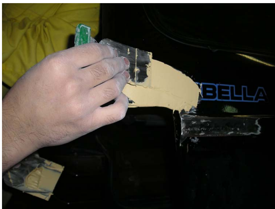
APLICACIÓN DE LA MASILLA
