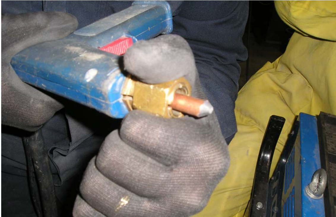
COLOCACIÓN DEL ELECTRODO DE CARBONO EN LA PISTOLA
