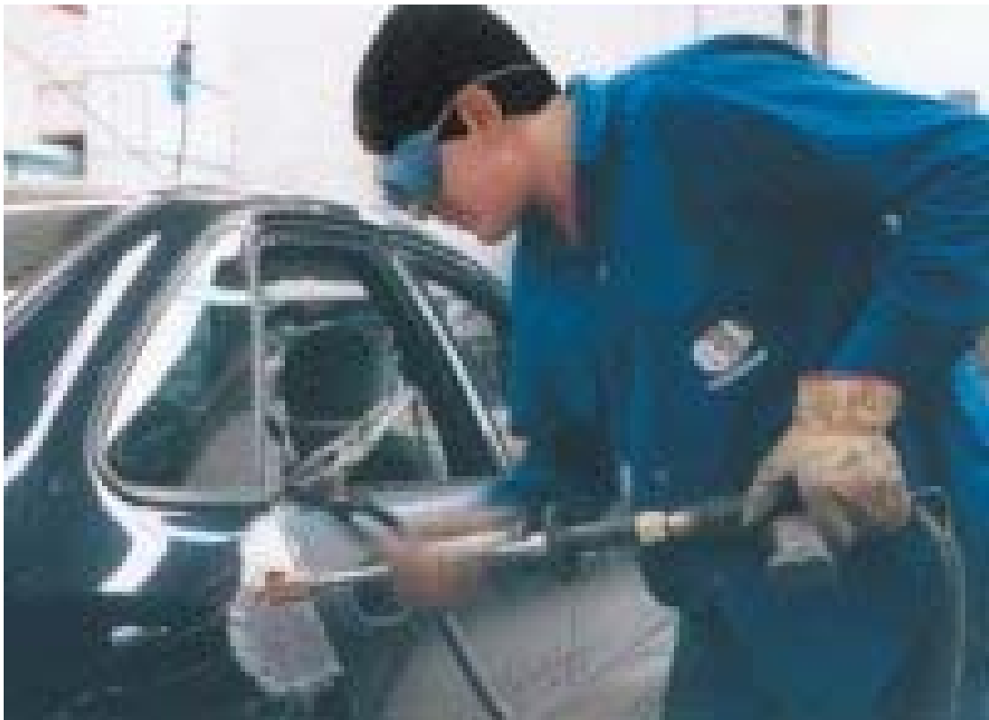
OPERARIO EMLEANDO UN MARTILLO DE INERCIA PARA EXTRAER UNA ABOLLADURA
