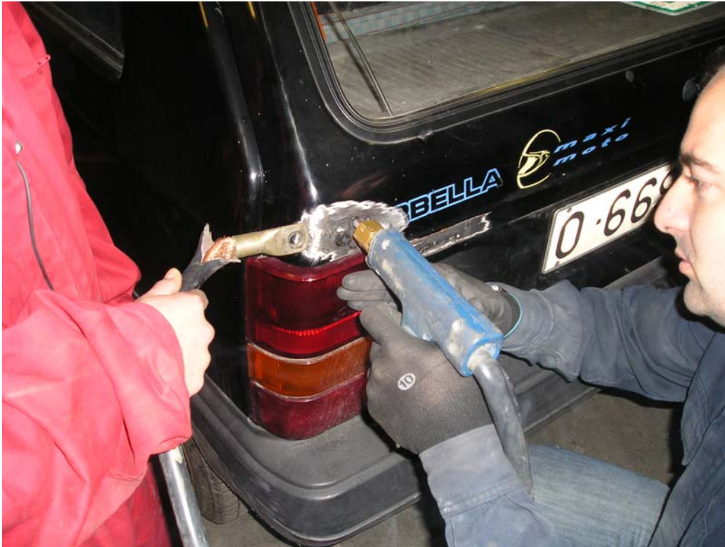
PROCESO DE SOLDADO DE LA ARANDELA DE SUJECCIÓN DE LA MASA
