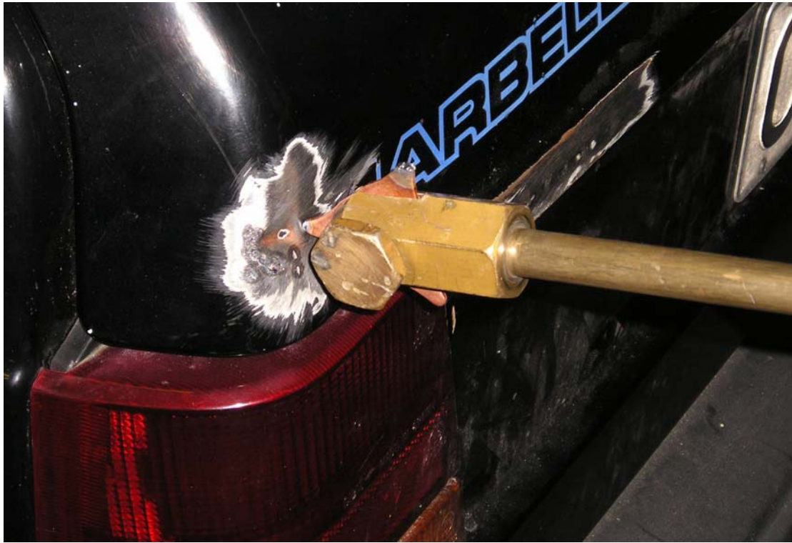
MOMENTO DE EN QUE SE PRODUCE LA UNIÓN DEL MARTILLO DE INERCIA
