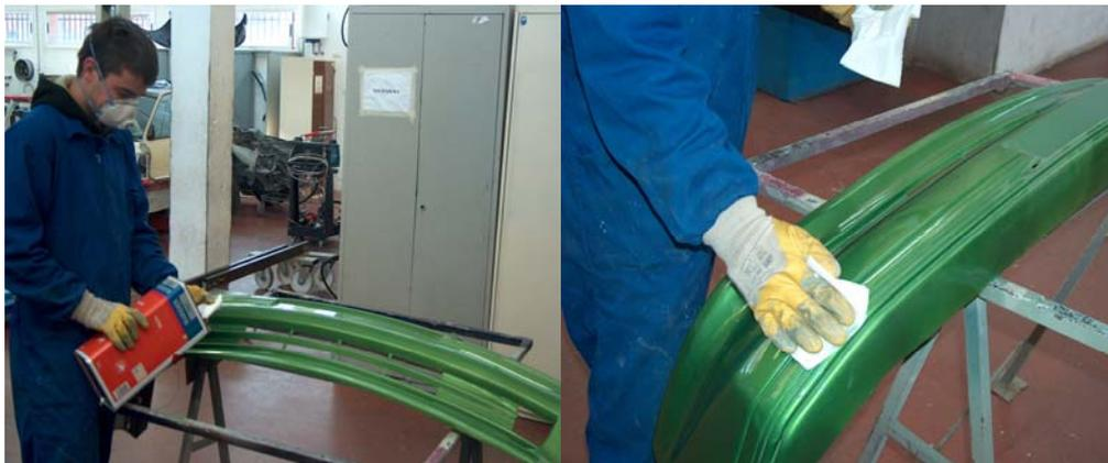
El primer paso consiste en realizar una limpieza exhaustiva con disolvente desengrasante. Con esta limpieza se elimina cualquier impureza o contaminante que presente la pieza, como grasas, residuos de desmoldeantes, polvo, etc
