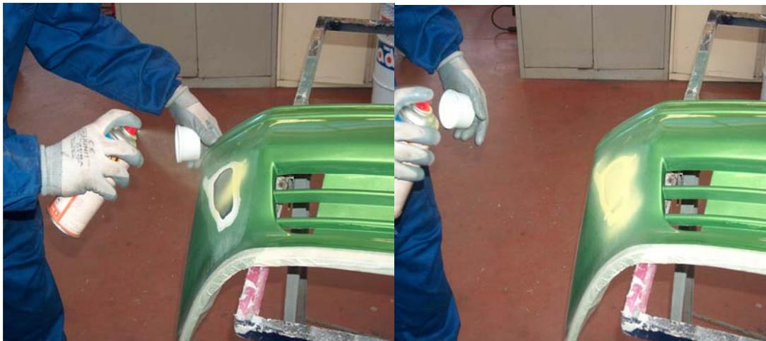
Lo aplicaremos con una doble función: proporciona la adherencia de la pintura de acabado y ofrece una buena base que aisle el acabado del plástico. Depende de el producto que usemos deberemos de pintar o no. Asimismo, tendremos que ver si necesita elastificante o no. Justo antes de aplicar la imprimación apestoso es conveniente pasar una bayeta atrapapolvo para eliminar partículas que pudieran haberse depositado sobre la superficie.
