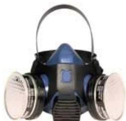
Las mascarillas de gases y vapores protegen de gases orgánicos y vapores tóxicos, están compuestas de dos filtros colocados en serie, un filtro de papel y fibras que atrapa partícula y después un filtro de carbono activo que atrapa los gases.
