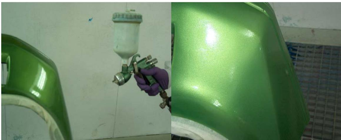
El pintado finaliza con la aplicación del laca para dar el brillo y dar resistencia a la capa de pintura. La mezcla de laca se elastifica para conseguir adaptarse a las deformaciones de la pieza plástica. Se aplica con diferentes pico de fluido que la pintura ya que esta es más líquida y necesita ser mas atomizada.
