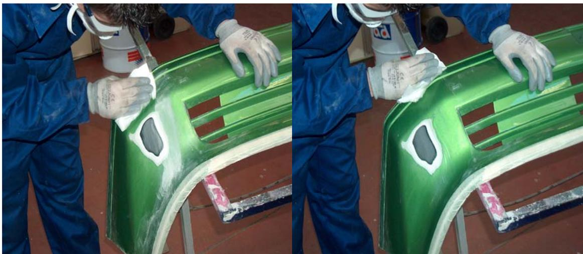
Los plásticos tienen una gran tendencia a adquirir cargas electrostáticas por frotación y, por lo tanto, a atraer partículas de suciedad hacia su superficie. Por ello, a continuación, se realiza una nueva limpieza. Esta vez, se utiliza papel y disolvente antiestático para arrastrar restos de suciedad y las partículas que puedan haberse desprendido del plástico durante el mateado anterior.
