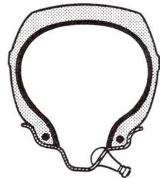
Corte esquemático de un neumático sin cámara para vehículo de turismo
