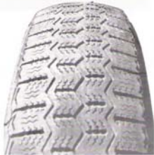
Bajo-inflado Desgaste redondo
