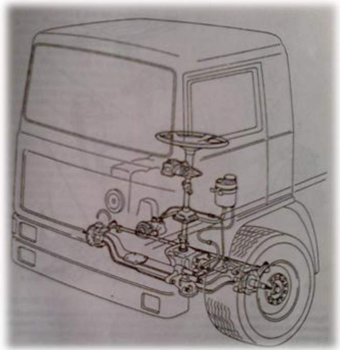
Disposición clásica de la dirección de un camión
