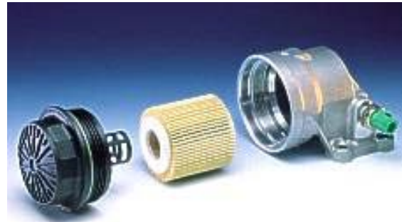
Figura 25. Desmontaje del filtro de cartucho
