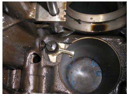
Figura 12. Inyector del circuito de lubricación.
