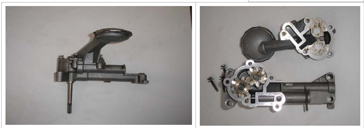
Figura 17. Bomba y despiece.
