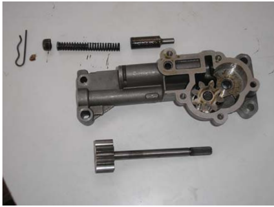
Figura 21. Despiece de la bomba
