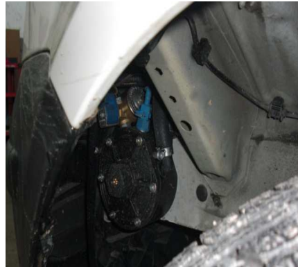
Imagen: Reductor instalado
