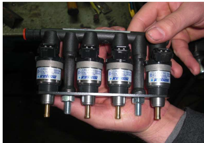
Imagen: Electroválvulas insufladoras de gas.
