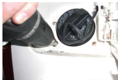
Imagen: Realización de taladro para toma de combustible GLP
