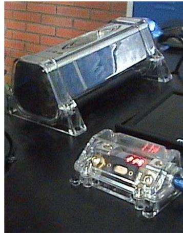
Una salida alimentara al subwoofer auto amplificado (4) y a la llave de contacto (5), que permitirá el paso de la corriente al cuadro de interruptores (6). Una segunda salida alimentara a otra caja de fusible (7) en el que se conectará el cable de memoria de algunos elementos, como el manos libres y la radio entre otros. La tercera salida de la primera caja de fusible alimentara al amplificador Alpine MRA-F355 (8).
