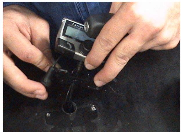
Para concluir nuestro equipo conectaremos el subwoofer amplificado, recibiendo la señal desde unas salidas de RCA que tiene el amplificador y de la radio conectaremos el remote al amplificador del subwoofer.
