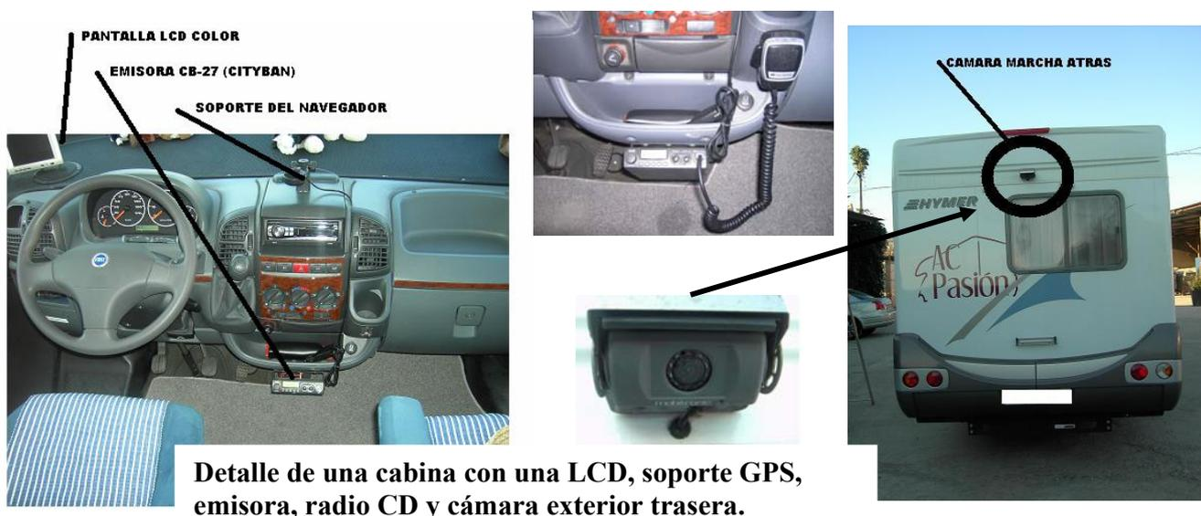
**Detalle de una cabina con una LCD, soporte GPS, emisora, radio CD y cámara exterior trasera.**
