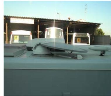
Antena parabólica plegada posición viaje
