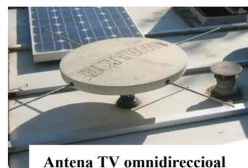
**Antena TV omnidireccional**
