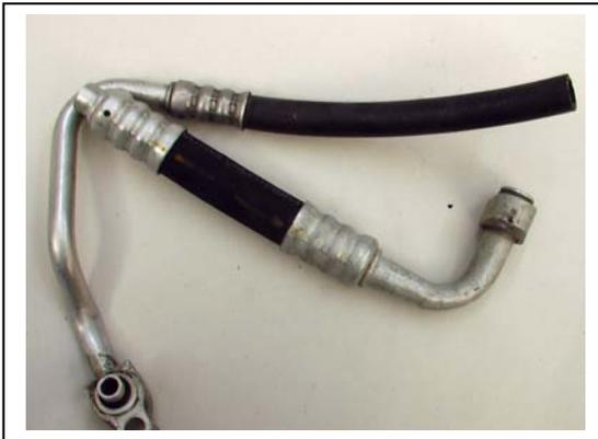
interior de goma recubierta de un trenzado de algodón, y una capa exterior, más porosa, de neopreno. Para el R134a se utiliza una capa interna de nailon recubierta del trenzado de algodón, y una capa externa del cloruro de butilio, que impide la entrada de humedad en el circuito
