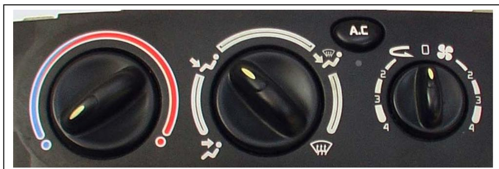
Mando de temperatura: identificado con los colores rojo y azul y conectado al grifo de calefacción o a la trampa de mezcla.
