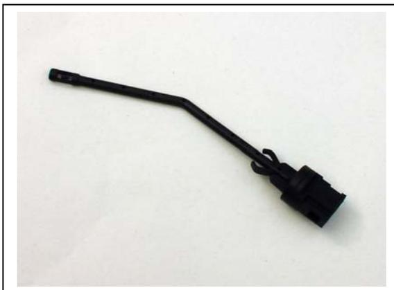
Informa permanentemente de la temperatura ambiente en el exterior del vehículo, y puede medir valores muy extremos (-40°C a +75°C). Es una resistencia NTC. Con el fin de que la medición sea lo mas exacta posible el sensor suele ir montado en un lugar donde el aire de la marcha no incida
