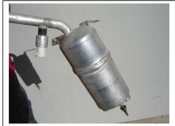
El fluido frigorífico entra en el depósito colector en estado gaseoso, se acumula en la parte superior y es aspirado por el compresor, de esta forma se asegura que únicamente aspire fluido en estado gaseoso. En caso de existir humedad, esta es retenida en el secador integrado en el depósito.
