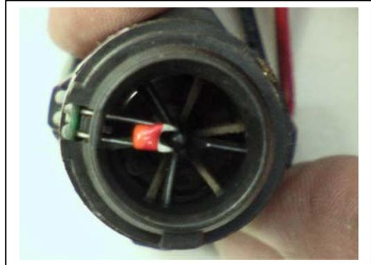
Si el sensor se avería, la unidad de control asume un valor sustitutivo de la temperatura solicitada, pero si le pedimos una temperatura distinta, el sistema producirá frío o calor sin parar y sin conseguir mantener la temperatura solicitada, ya que no conoce la temperatura interior.
