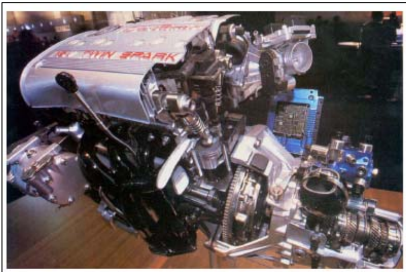
Selespeed acoplado a un motor alfa
