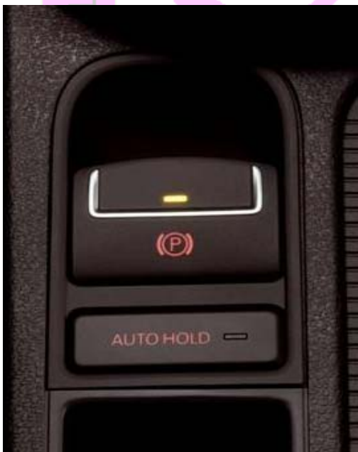
Pulsador para activar/desactivar AUTO HOLD
