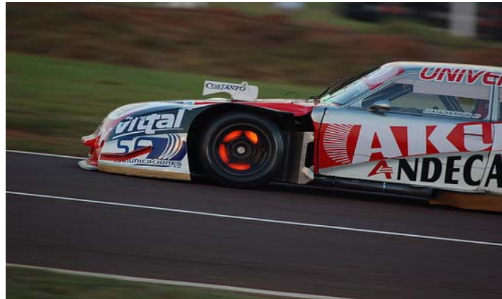
Fig. 11. Vehículo de carreras en el que se aprecia las grandes temperaturas que alcanza un disco de freno
