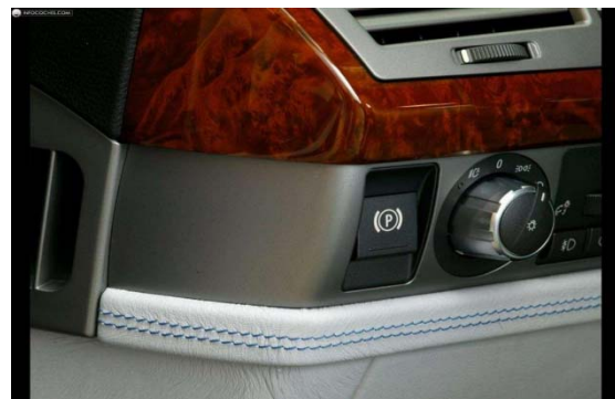
Fig. 8. Freno de estacionamiento accionado mediante un botón (P)
