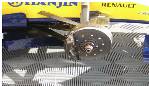
Fig. 19. Freno de carbono de un monoplaza de F1
