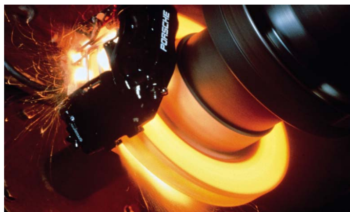
Fig. 12. Disco de freno cerámico sometido a grandes esfuerzos.
