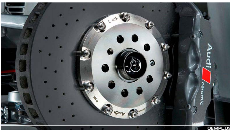
Fig. 14. Freno cerámico del Audi R8 en el que se ven claramente los taladros.
