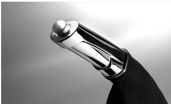
Fig. 7. Freno de estacionamiento accionado mediante una palanca.
