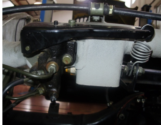
fig. 6. Repartidor de frenada respecto al peso del eje trasero.
