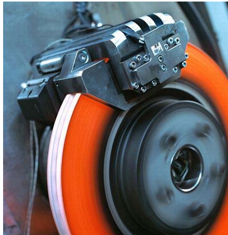
Fig. 22. Sistema de freno de cuña diseñado por Siemens VDO.
