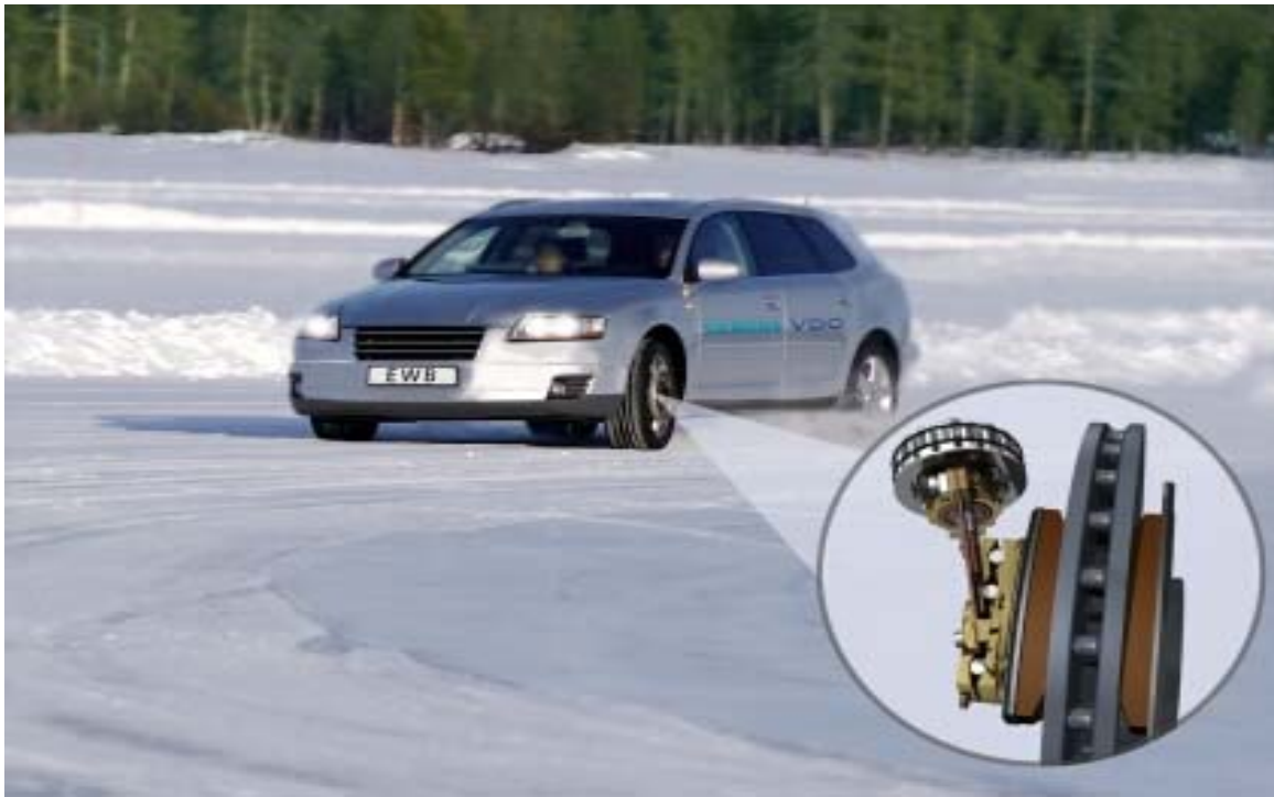
Fig. 24. Prueba del sistema de freno de cuña en condiciones adversas.
