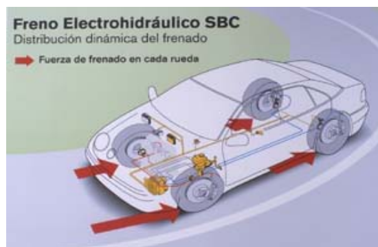
Fig. 26. demostración del reparto de frenada en cada rueda.
