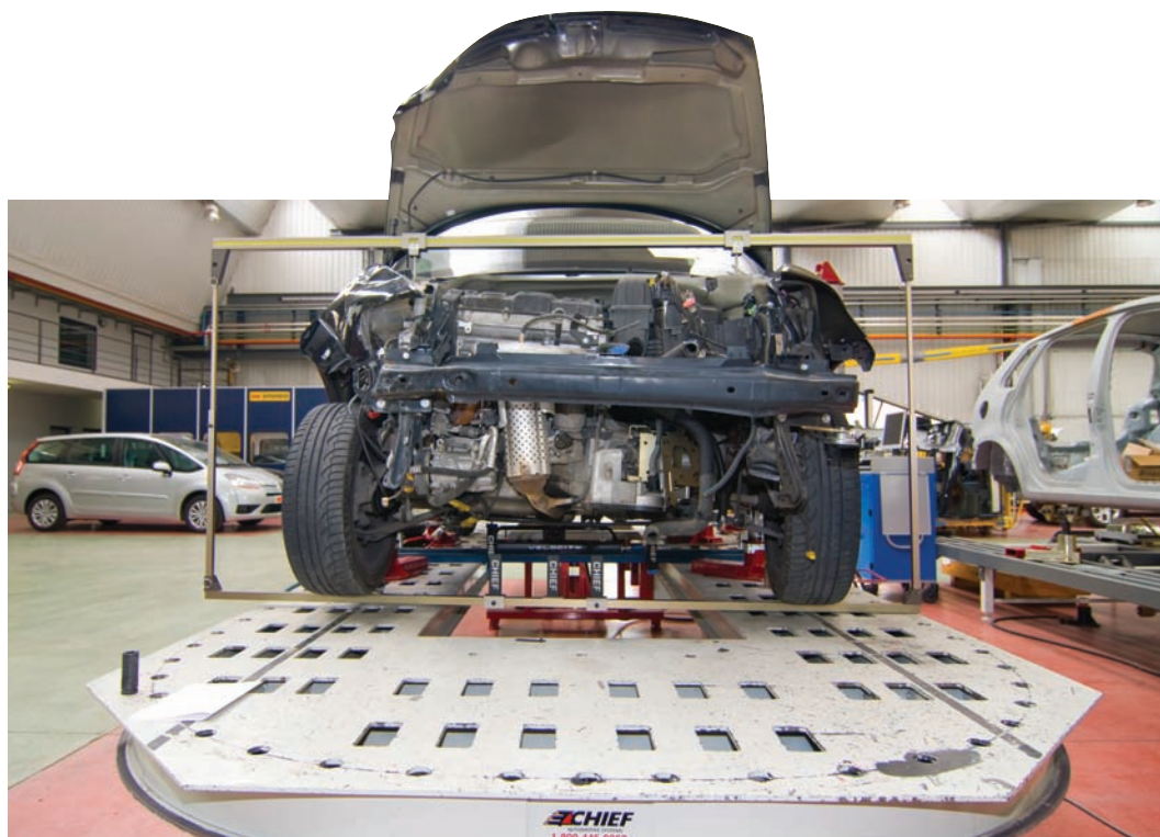
Medición de las torretas de suspensión
