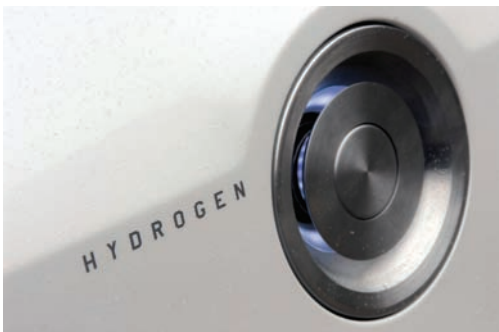
► Boca de carga de hidrógeno a presión
