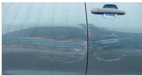
▸ Daños en el lateral producidos por un bolardo
